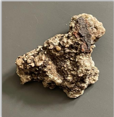
上圖：本室過去研究忠靈塔時 在四周叢林內發現忠靈塔1947年爆破時候殘留的碎片 第一塊為混凝土牆掃上白色灰水層 第二塊 混凝土沙石及鋼筋遺存 [11] 圖片來源：延陵科學綜合室藏
