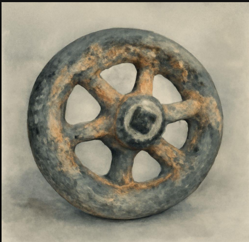
定遠的水龍頭輪閥被大海的泥砂侵蝕，銅閥直徑為9.5cm、閥厚1.6cm，重513克。 圖片來源：延陵科學綜合室
