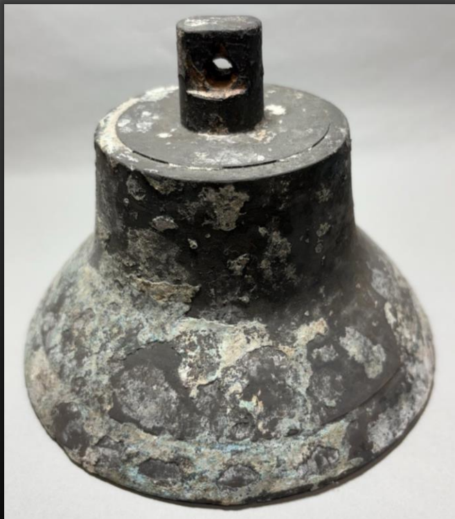
上圖：銅鐘直徑大概，為15.5cm、鐘高12cm，重1327克的定遠艦訊號鐘。圖片來源：延陵科學綜合室
